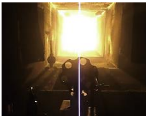
Obrázek 3 – Digitální fotografie žlutě hořící slože ve fotometrickém tunelu [8]
