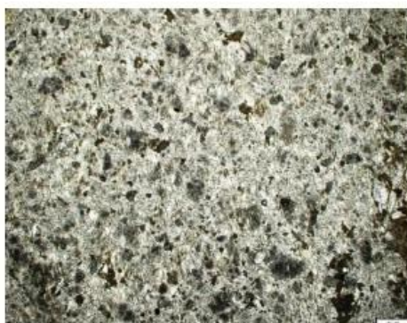
Mikrofotografie struktury vzorku s převažujícími krystaly kalcitu, pozorováno v procházejícím světle. Měřítko: 0,5 mm.
