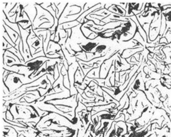
Obrázek 10 Příklad struktury litiny s lupínkovým grafitem [9]
