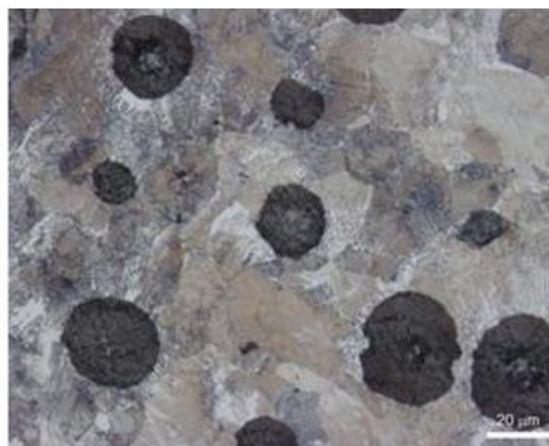
Obrázek 11 Příklad struktury litiny s kuličkovým grafitem [9]
