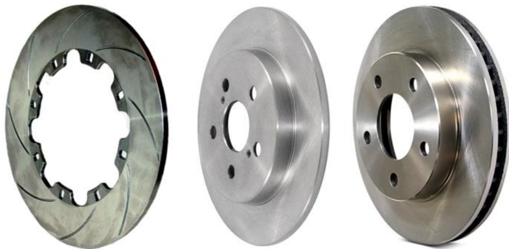
Obrázek 9 Provedení brzdových kotoučů: plochý, hrcovitý, hrcovitý s odvětráním [8]
