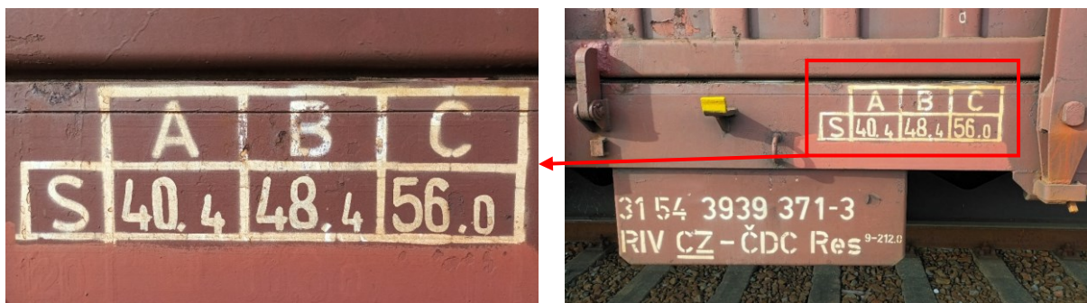
Obr. 2 – Tabulka s údaji o maximální ložné hmotnosti na voze řady RES, konstrukční skupiny 51
