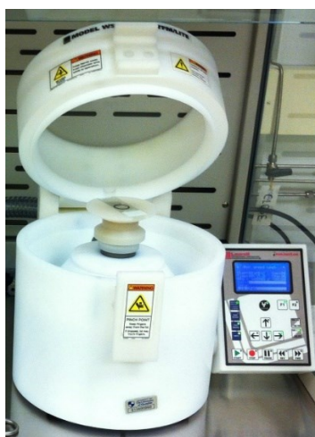
Obrázek 14: Spin-coater Laurell WS-650MZ-23NPPB
