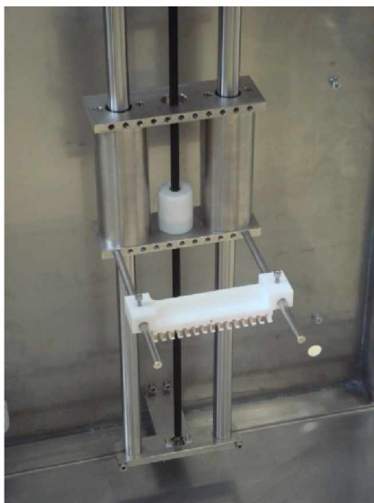
Obrázek 1: Detail lineárního vedení smáčecího zařízení [14]
