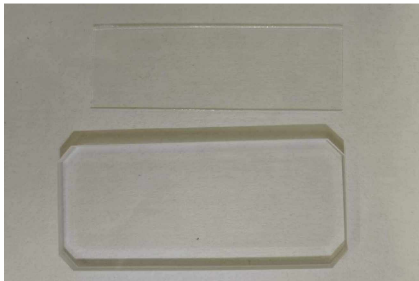
Obrázek 8: Použité skleněné substráty, na které byly naneseny tenké vrstvy fotokatalyzátorů, malé sklo pro charakterizační techniky (nahore), velké sklo pro použití v mikroreaktoru (dole)
