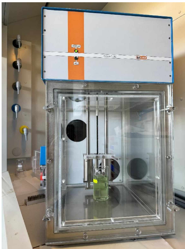
Obrázek 6: Fotografie dipcoateru použitého k přípravě tenkovrstvých fotokatalyzátorů
