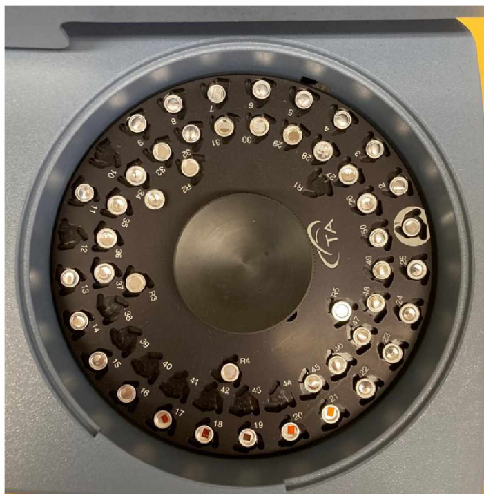
Obrázek 19: Autosampler přístroje DSC Q2000 (TA Instruments)
