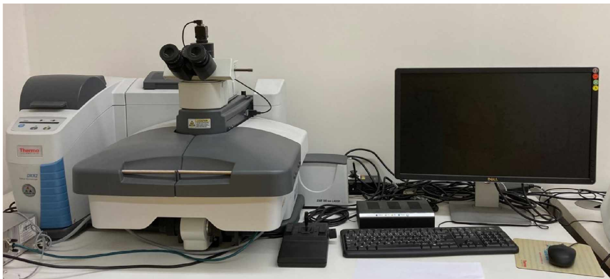
Obrázek 24: Ramanova spektroskopie; vlevo: Ramanův mikroskop; vpravo: Počítač
