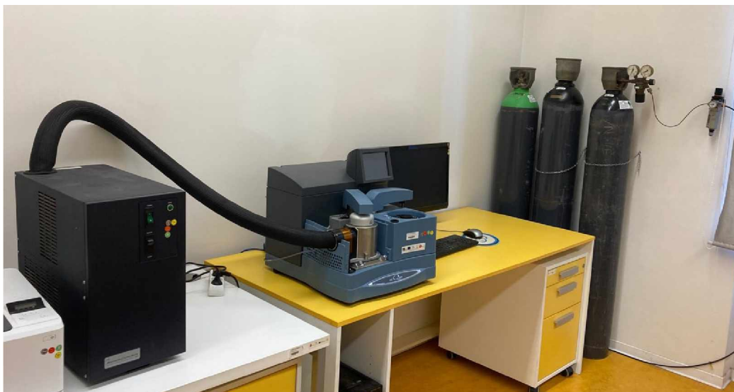
Obrázek 17: Kompletní uspořádání diferenčního skenovacího kalorimetru: Vlevo: Chladicí zařízení; uprostřed: DSC; vpravo: Tlakové lahve
