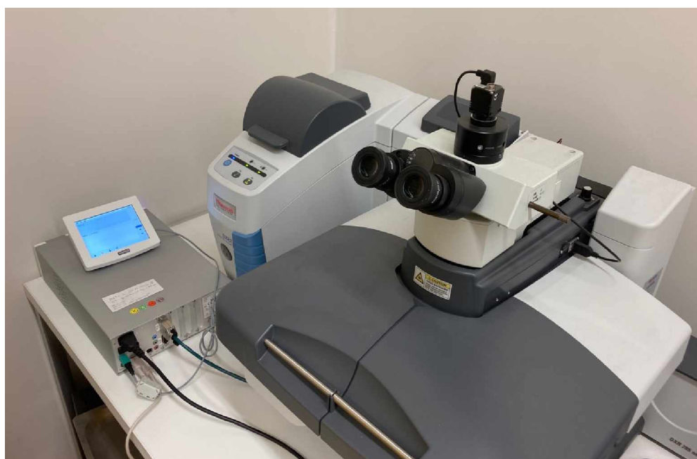
Obrázek 25: Ramanova spektroskopie; vlevo: Teplotní čidlo; vpravo: Ramanův mikroskop DXR2 (Nicolet)
