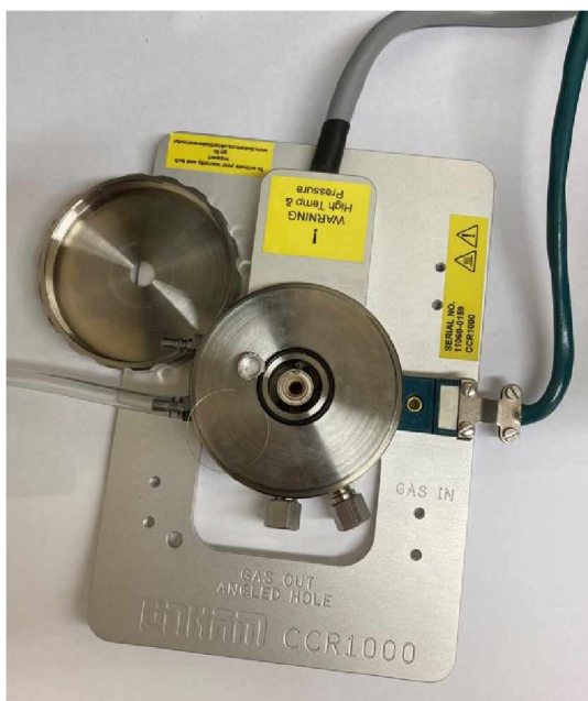
Obrázek 26: Teplotní cely CCR1000 Ramanova mikroskopu DXR2 (Nicolet)
