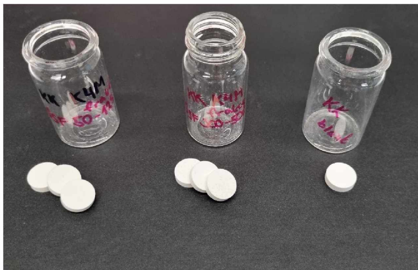
Obrázek 25: Nalisované tablety, griseofulvin amorfni frakce 50 – 125 \mu\text{m} , griseofulvin amorfni frakce 300 – 500 \mu\text{m} a blank.
