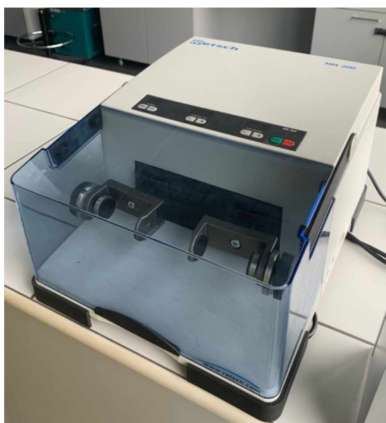
Obrázek 16: Homogenizátor používaný při plnění tobolek.
