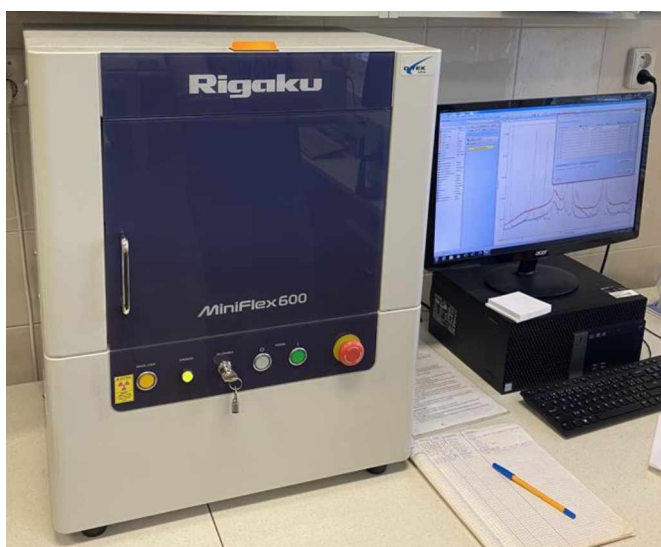
Obrázek 15: Zařízení MiniFlex 600, použito k měření XRD spekter.
