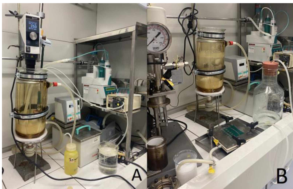
Obrázek 14: (a) - aparatura určená k srážení LDH, (b) - aparatura určená k filtraci vzniklé sraženiny.
