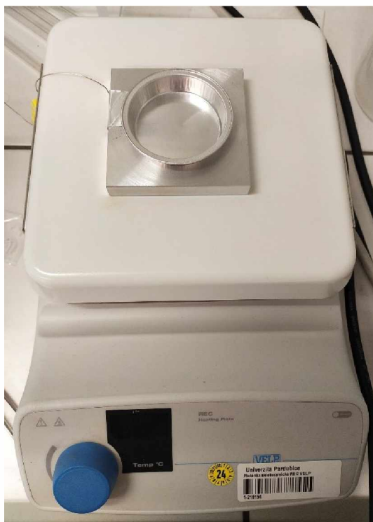
Obrázek 5: temperační stolek s kelímkem a termočlánkem
