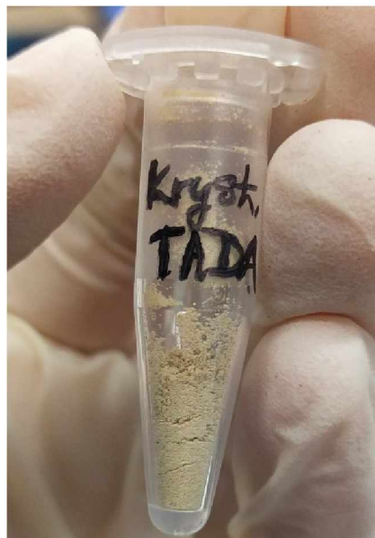
Obrázek 12: zakrytalizovaný TADA připravený z amorfniho vzorku
