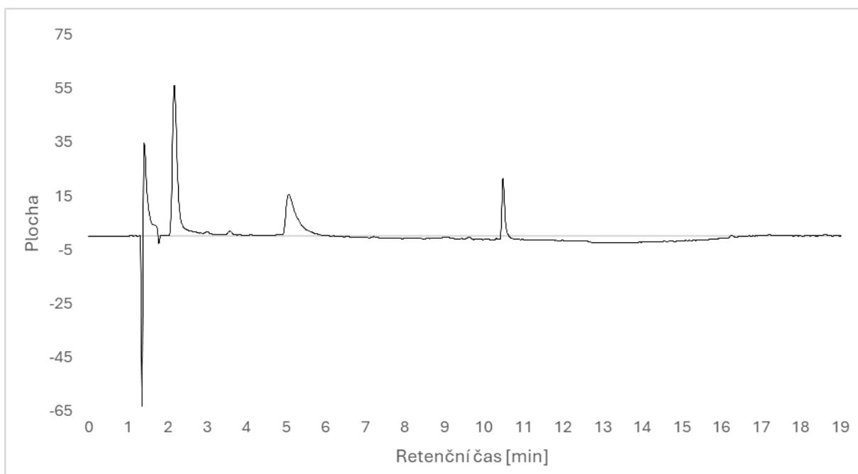
Obrázek 51. Chromatogram vzorku 3 v DMSO, navážka 5 mg/10 ml, UV detekce při 254 nm, další podmínky viz obr. 42
