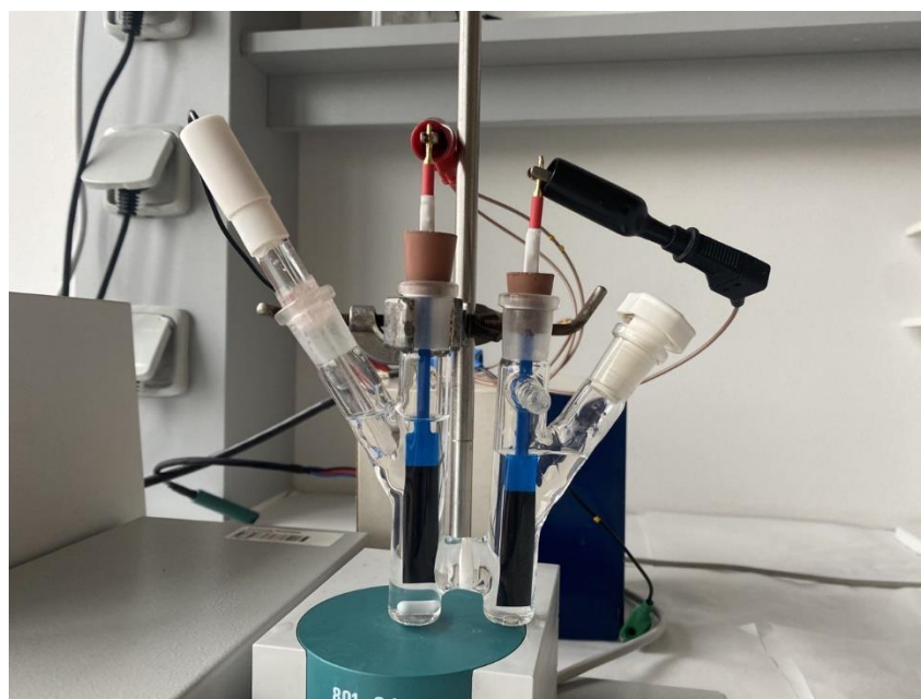
Obrázek 9 Elektrochemický článek pro preparativní elektrolyzu s velkoplošnými BDD
