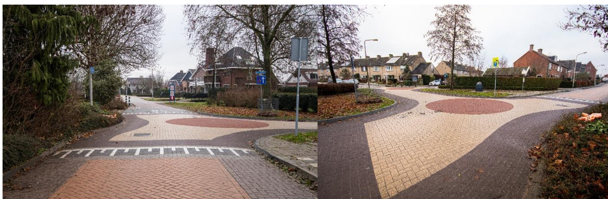
Obrázek 25 Styková křižovatka ve zklidněné zóně řešená vidlicovitým tvarem
