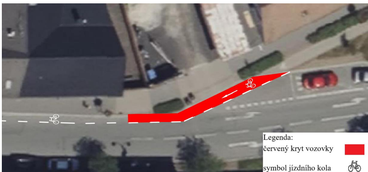
Obrázek 50 Napojení ochranného pruhu pro cyklisty
