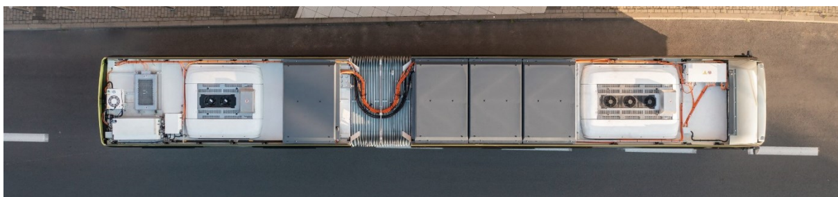
Obrázok 23 Rozloženie strechy elektrobusu Solaris Urbino 18 IV
