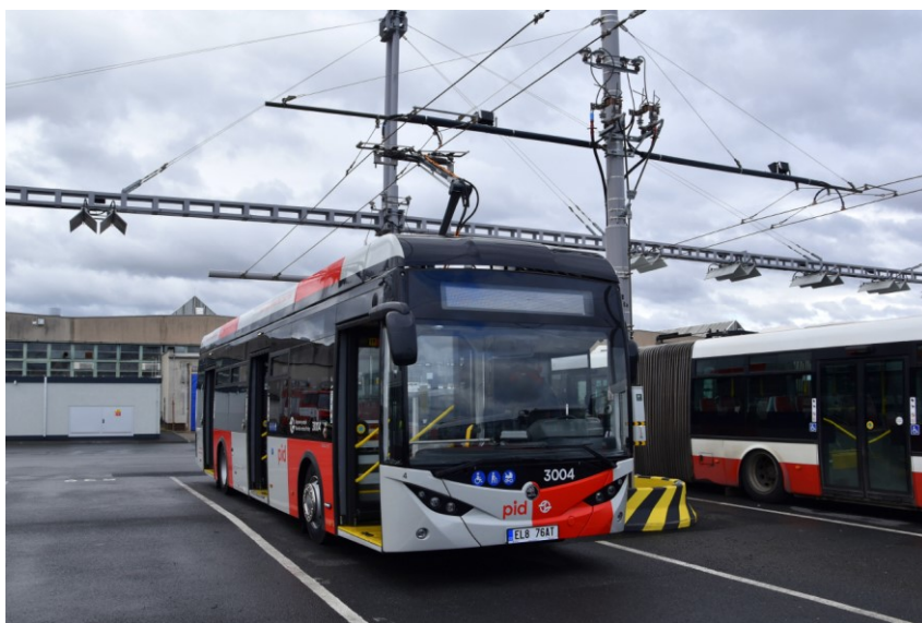
Obrázek 4 Dvoupólové nabíjení elektrobusů v garážích Klíčův v Praze. Zdroj: Jakub Gulyás
