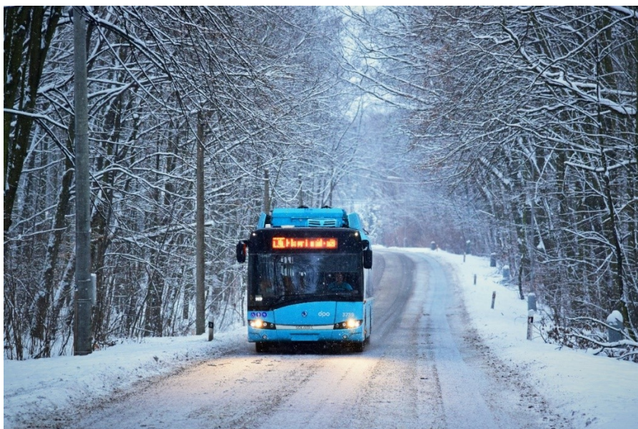
Obrázek A 4 Parciální trolejbus Škoda 26 Tr Solaris nasazený na ostravskou linku 101, jež nahradila autobusovou linku 29. Zdroj: foto autor
