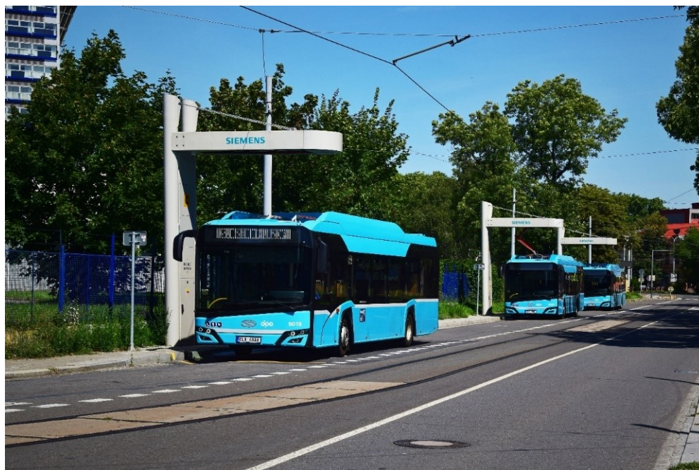
Obrázek A 2 Elektrobusy Solaris Urbino 12 IV Electric během procesu nabíjení na ulici Valchařské v Ostravě, kde jsou umístěny hned 3 nabíjecí ramena.. Zdroj: foto autor
