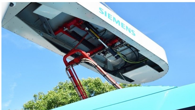
Obrázek A 1 Spuštěný reverzní pantograf zprostředkující nabíjení ostravského elektrobusu systému Oppcharge. Zdroj: foto autor
