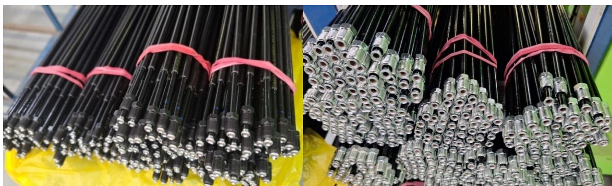
Obrázek 7 - Napertlované trubky z prvního ATL stroje
