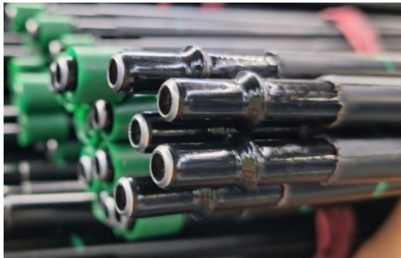
Obrázek 8 - Jiný typ pertlu (bead) z druhého ATL stroje
