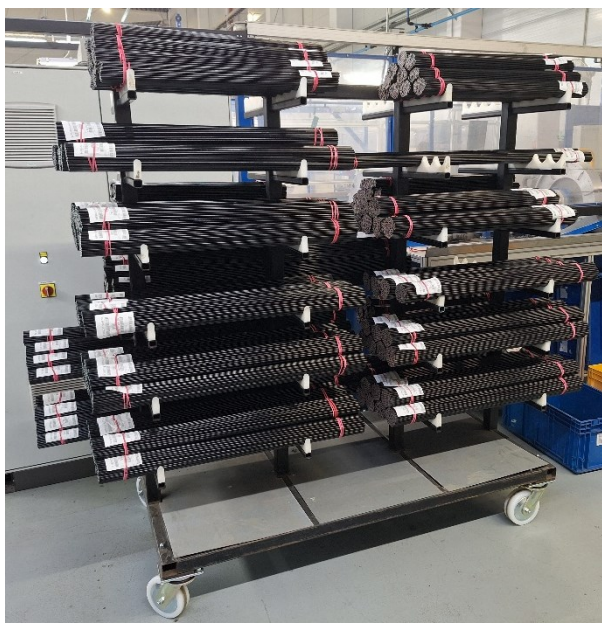
Obrázek 14 - Pohyblivý stroměčkový regál se svazky trubek
