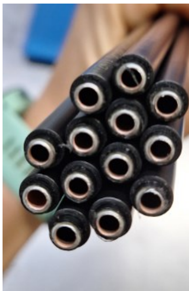
Obrázek 2 - PP vrstva na trubce po řezu
