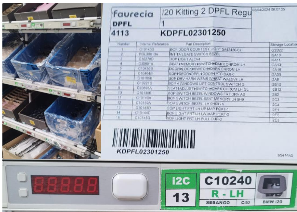
Obrázek 15 Pick-by-Light systém a seznam pro kompletaci (autor)
