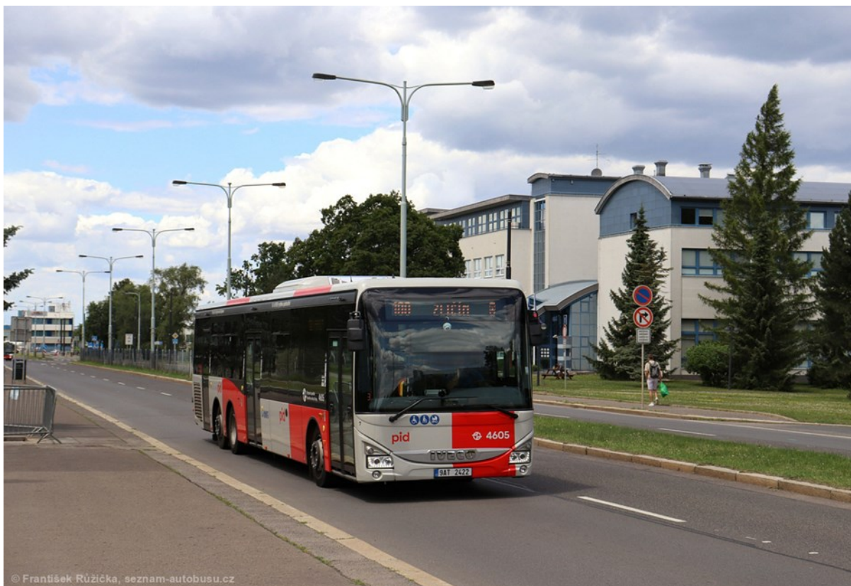
Obrázek 14: Patnáctimetrový low-entry autobus Iveco Crossway LE CITY 14.5M, Zdroj: (foto František Růžička)
