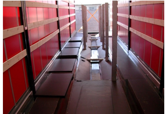
Obrázek 26 Wielton coilmulde zevnitř Zdroj: (25)
