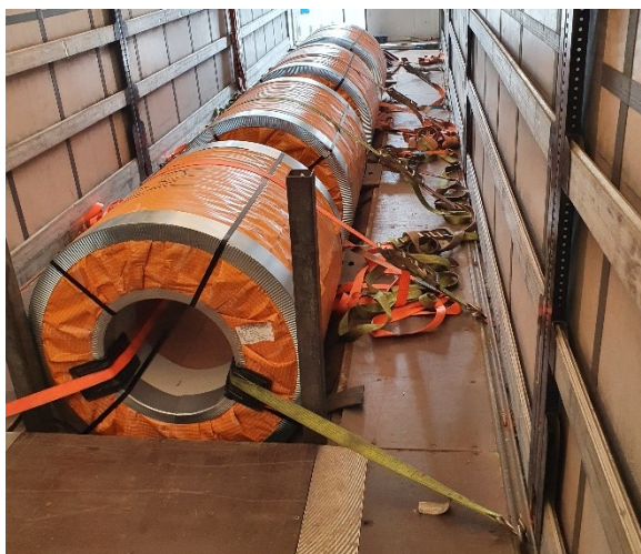
Obrázek 9 Svitky naložené v korytě návěsu Zdroj: foto autor
