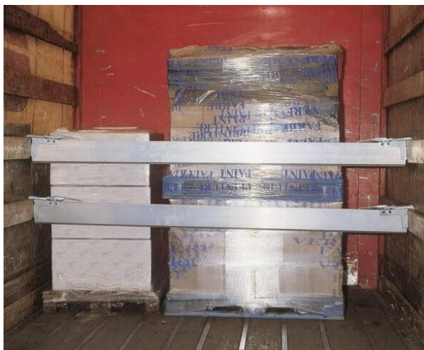
Obrázek 11 Rozpěrné tyče upevněné vodorovně Zdroj: (8)
