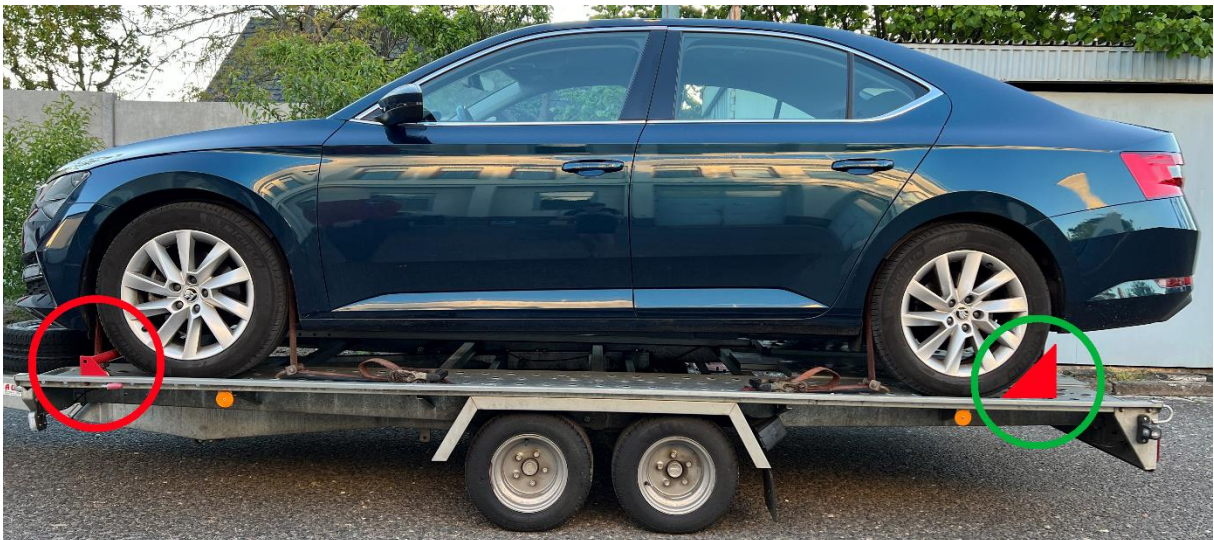
Obrázek 22 Schematicky vyznačen blokovací klín
