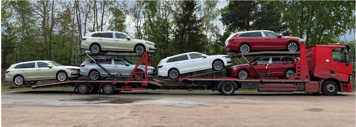
Obrázek 26 Plně naložená a zajištěná autotransportérová souprava
