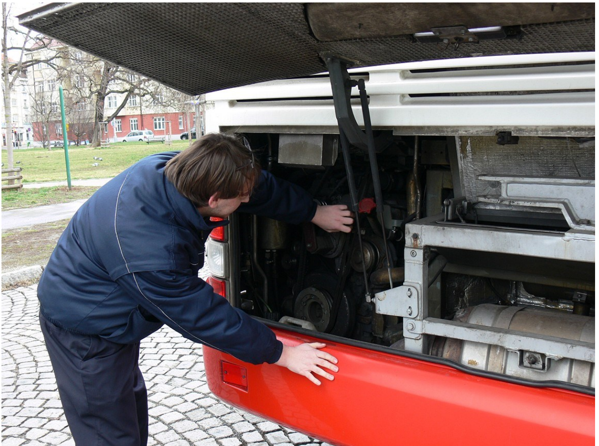
Obrázek 2: Kontrola řemenů v motorovém prostoru na konečné zastávce
