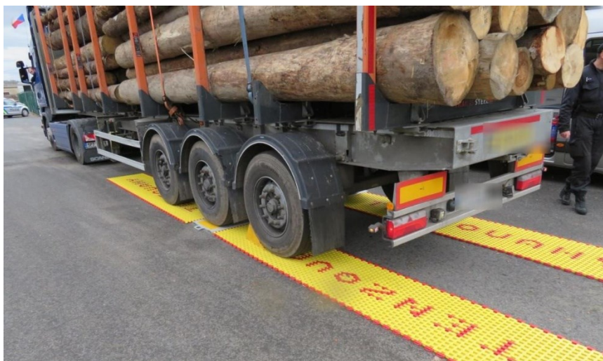
Obrázek č. 1 Kontrolní vážení vozidla
