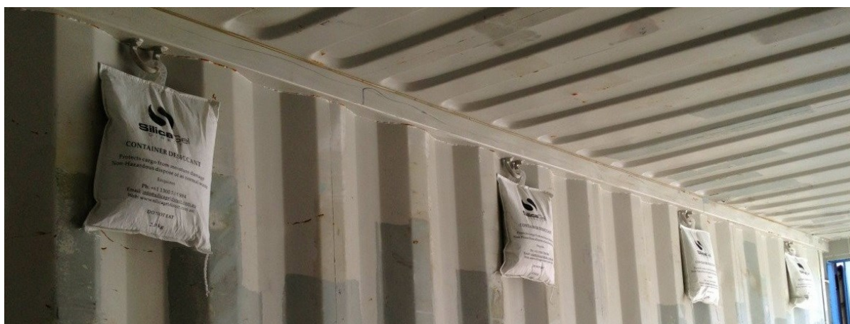
Obrázek č. 8 Silikagelové sáčky proti vlhkosti Zdroj (8)
