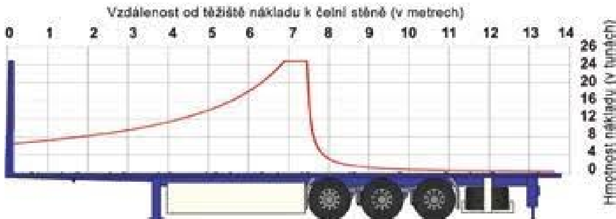
Obrázek č. 3 Diagram rozložení nákladu na třínápravovém návěsu Zdroj (3)
