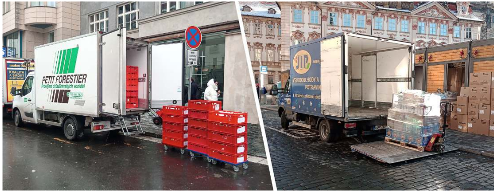
Obrázek 2.16: Příklady zásobování přepravkami s přepravním vozíkem (vlevo) a paletou s paletovým vozíkem za pomoci hydraulického čela (vpravo) 18
