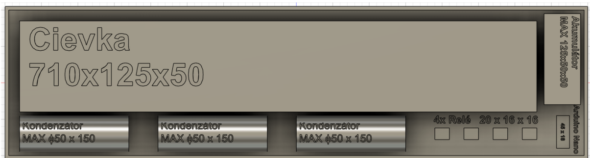
obr. 19 Rozloženie prvkov v boxe emulátora
