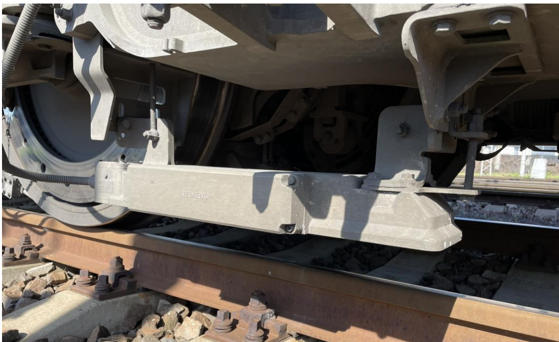
obr. 14 Vozidlový magnet upevnený na rám podvozku
