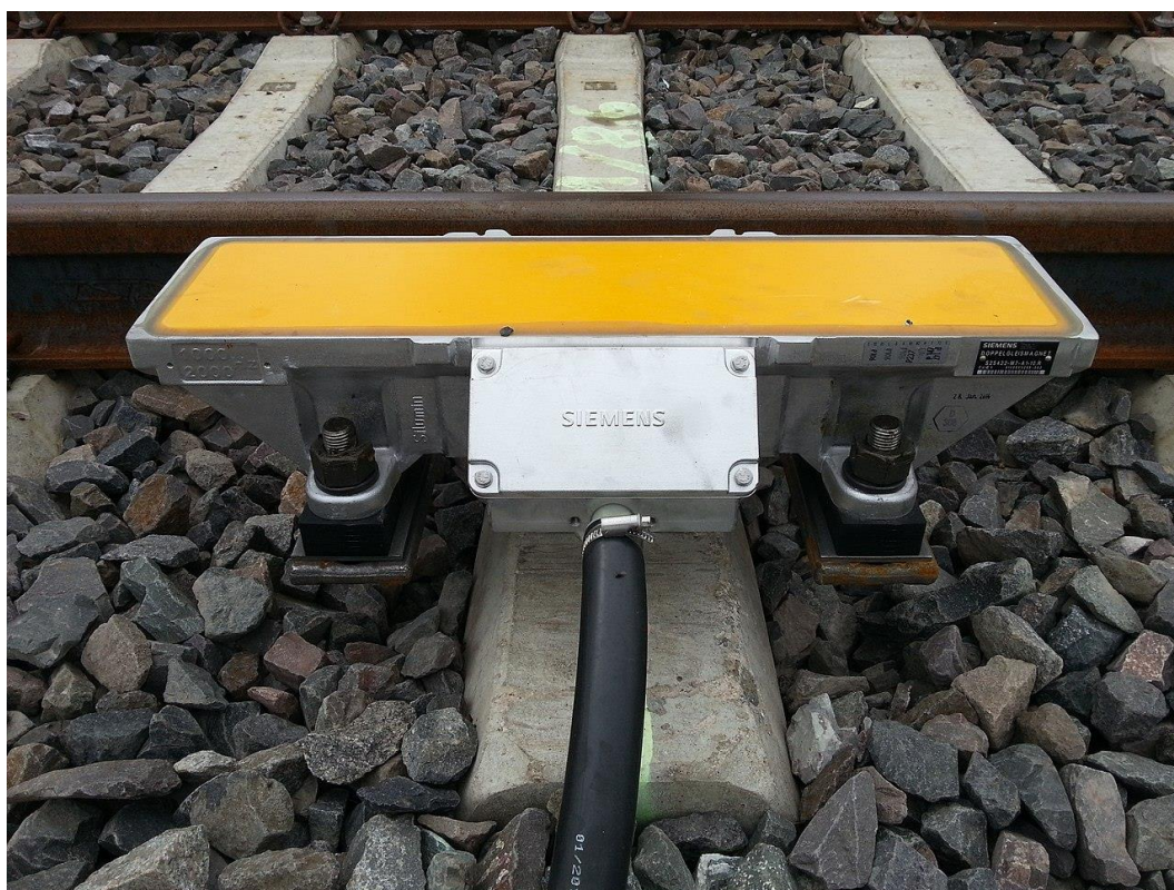
obr. 9 Traťový magnet pre 1000 a 2000 Hz (pozdĺžne kratší) [1]
