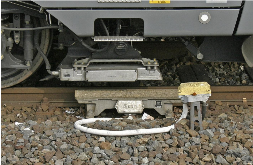
obr. 10 Traťový magnet pre 500 Hz (pozdĺžne dlhší) [1]
