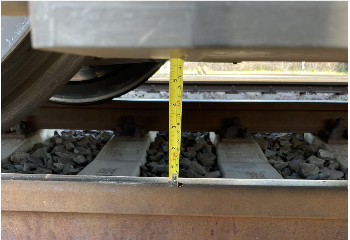
obr. 7 Výškové umiestnenie vozidlového magnetu
