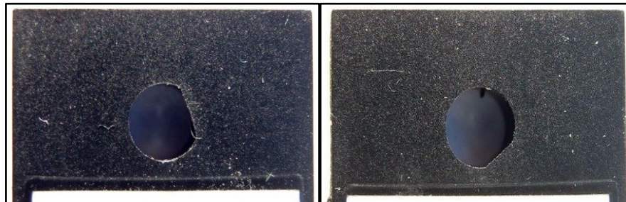
Obr. 18: Otřepy v montážním otvoru
