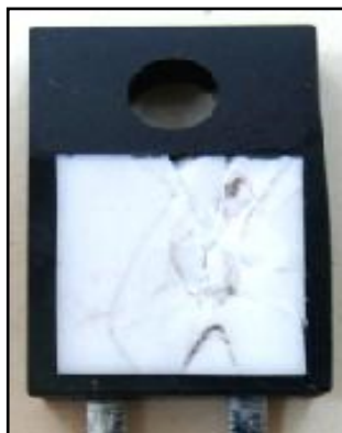
Obr. 13: Velmi popraskaná keramika
