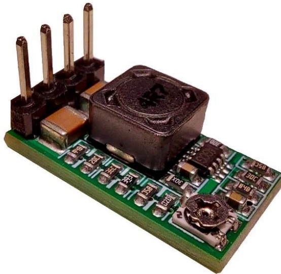
Obr. 34 – DC-DC Step-down měnič s čipem MP2315. Měnič B.
