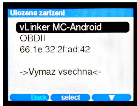
Obr. 59 – Detail na displej převodníku. Seznam uložených OBD adaptérů v nevolatilní paměti zařízení.
