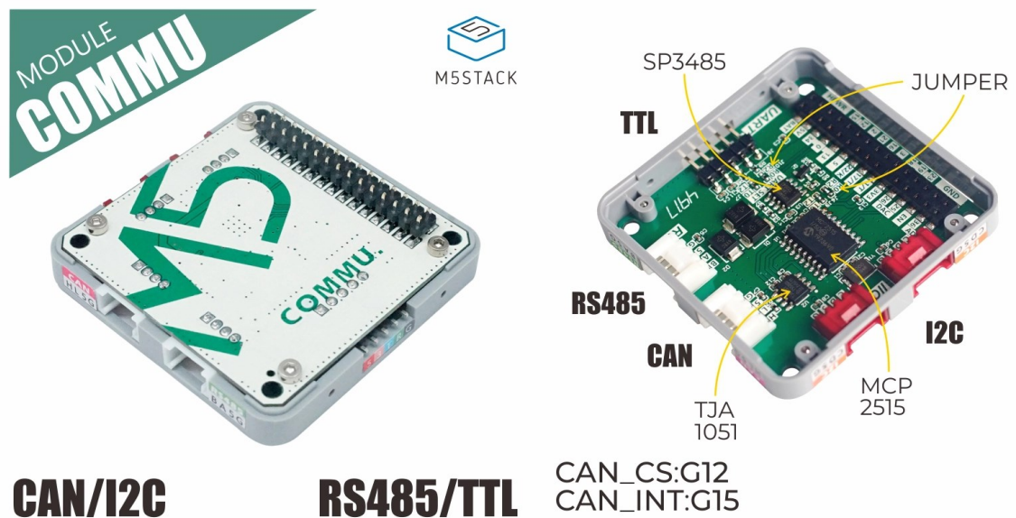
Obr. 31 – COMMU modul. Vlevo zařízení, vpravo rozvržení komponent. Zdroj [5].
