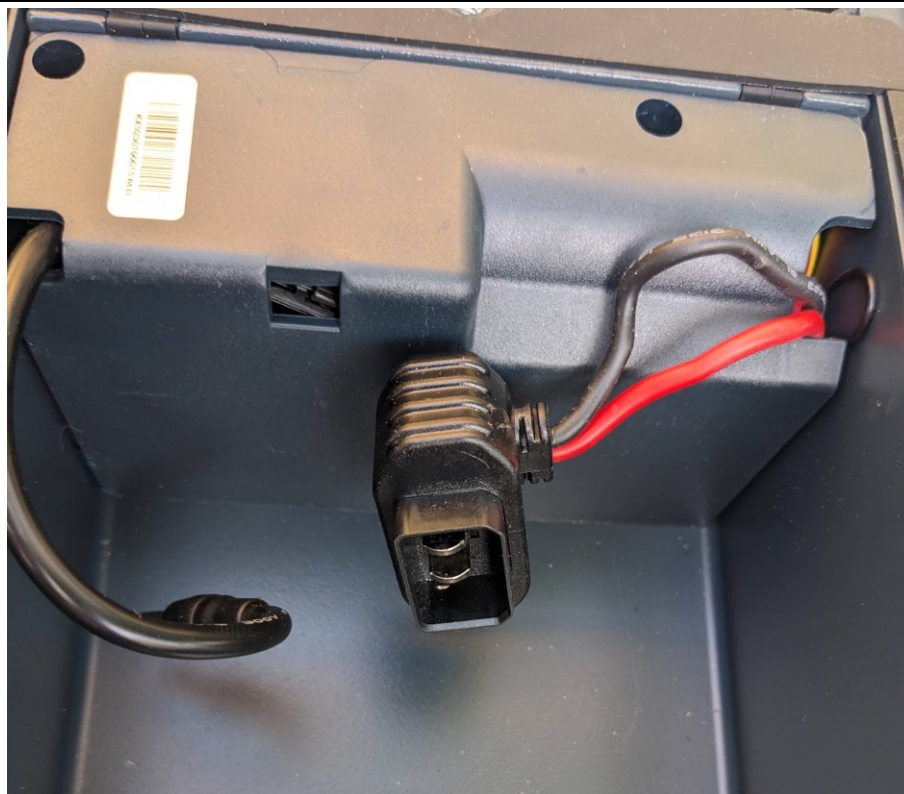
Obr. 3: Detail konektoru spojující elektrokoloběžku s akupackem
