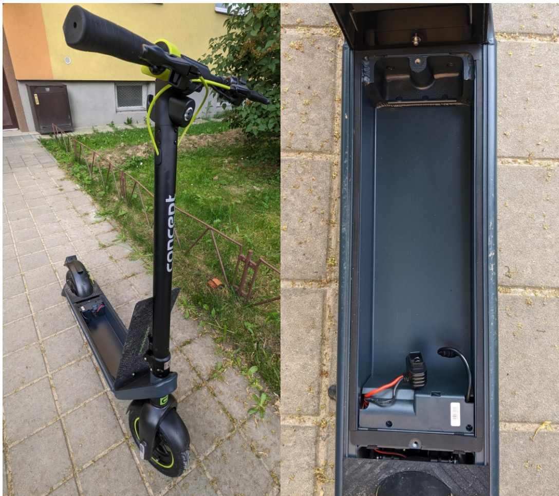
Obr. 12: Pohled na zakoupenou koloběžku (vlevo), detail úložného prostoru akupacku (vpravo) (autor)
