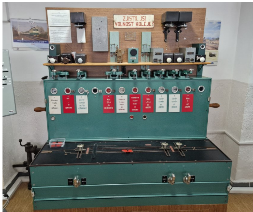
Obr. 3 Hradlový prístroj RANK v stanici Dřísy (pozri tiež príloha 4)
