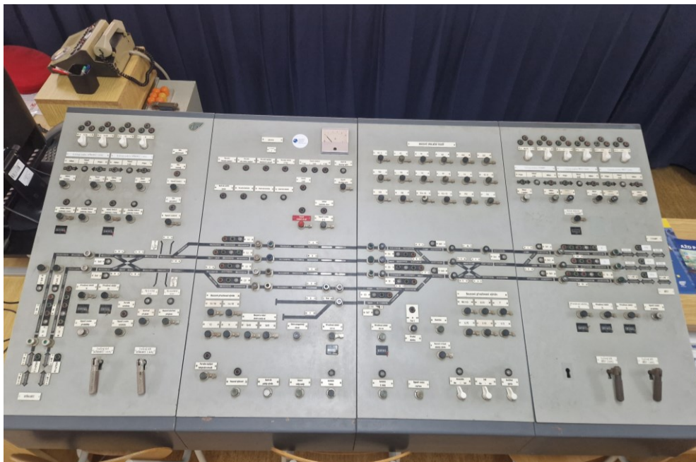
Obr. 2 Riadiaci pult RZZ AŽD-71 v stanici Obora (pozri tiež príloha 3)
