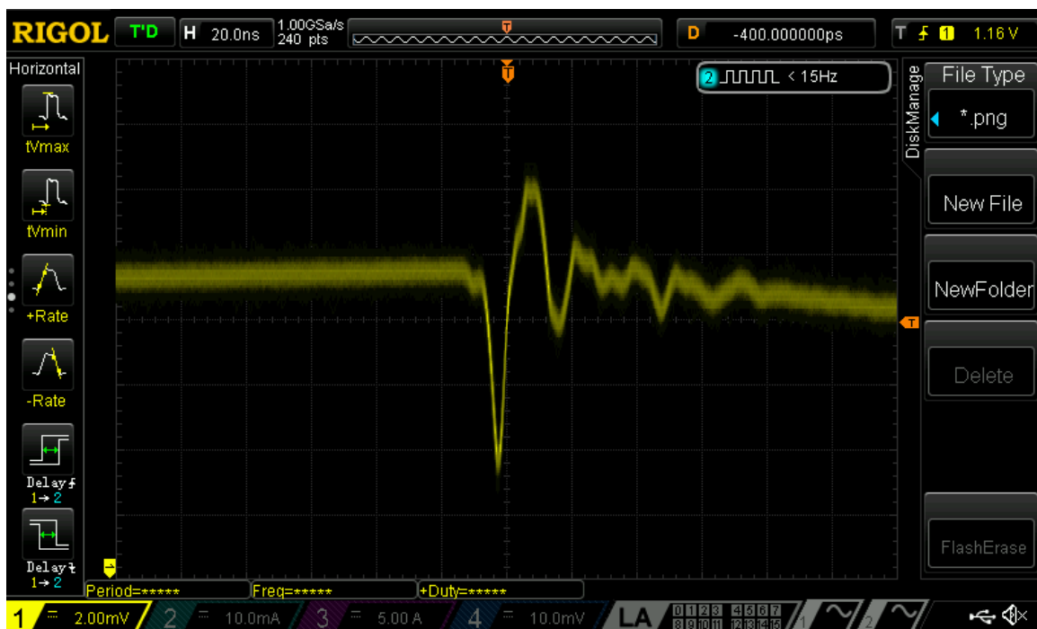
Obr. 24 – Detail na průběh proudu cívkou u AL8860
