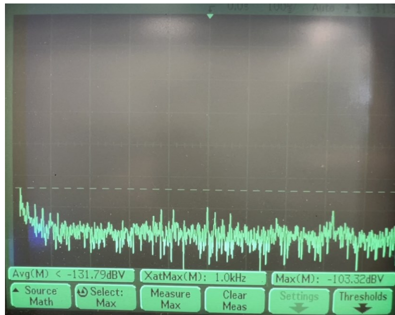
Obr. 33 – Vstupní frekvenční spektrum AL8860 při střídě rovné 0,2 (zdroj modré barvy)
