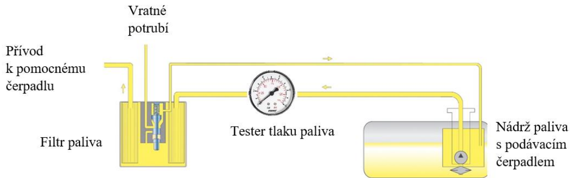
Obrázek 29: Připojení testeru tlaku paliva na měření podávacího čerpadla [15]
