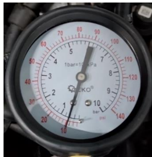
Obrázek 30: Tlak palivového čerpadla
