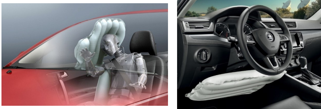
Obrázek 37 vlevo hlavový airbag [14], vpravo kolenní airbag [15]
