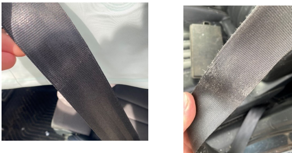
Obrázek 52 Stopa na popruhu od spony vlevo, od průvlečného oka vpravo
