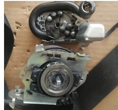
Obrázek 56 Rozebraný kuličkový předpínač
