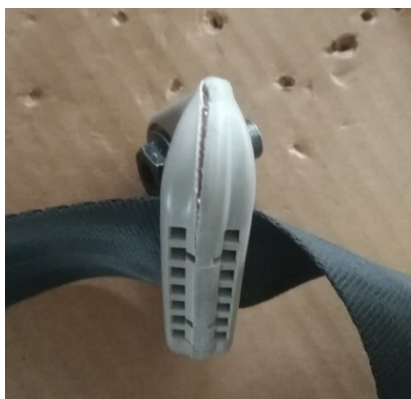
Obrázek 55 Vlevo prasklé průvlečné oko Peugeot, Vpravo prasklé průvlečné oko Xsara
