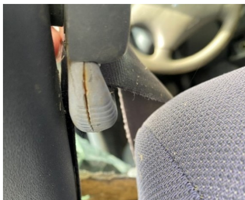
Obrázek 55 Vlevo prasklé průvlečné oko Peugeot, Vpravo prasklé průvlečné oko Xsara
