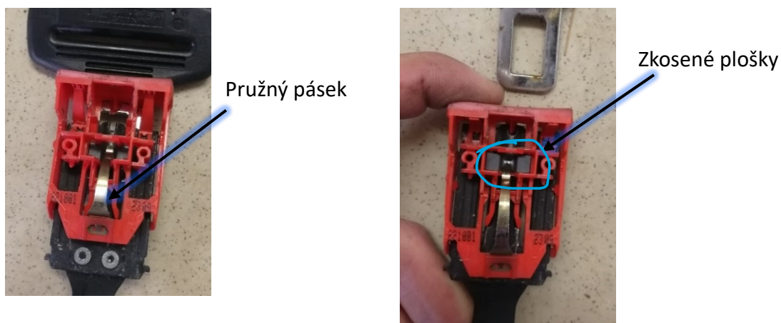
Obrázek 8 Zapnutá spona do zámku (vlevo), rozepnutý zámeček (vpravo) zámeček
