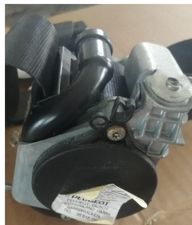
Obrázek 24 Vlevo schéma kuličkový předpínač, vpravo navíječ s předpínačem peugeot
