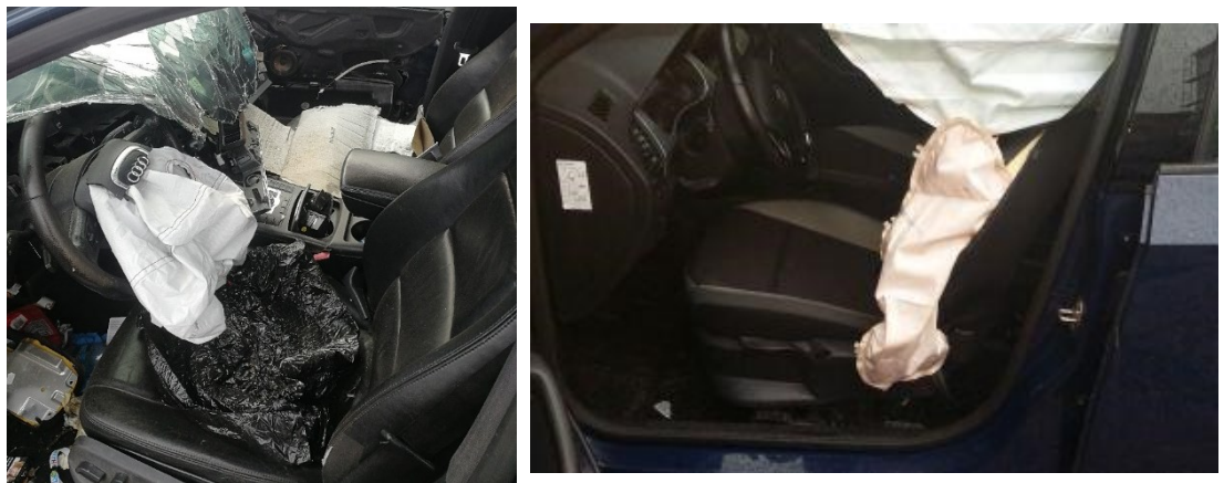
Obrázek 36 vlevo vystřelený čelní airbag, vpravo vystřelený boční airbag [13]
