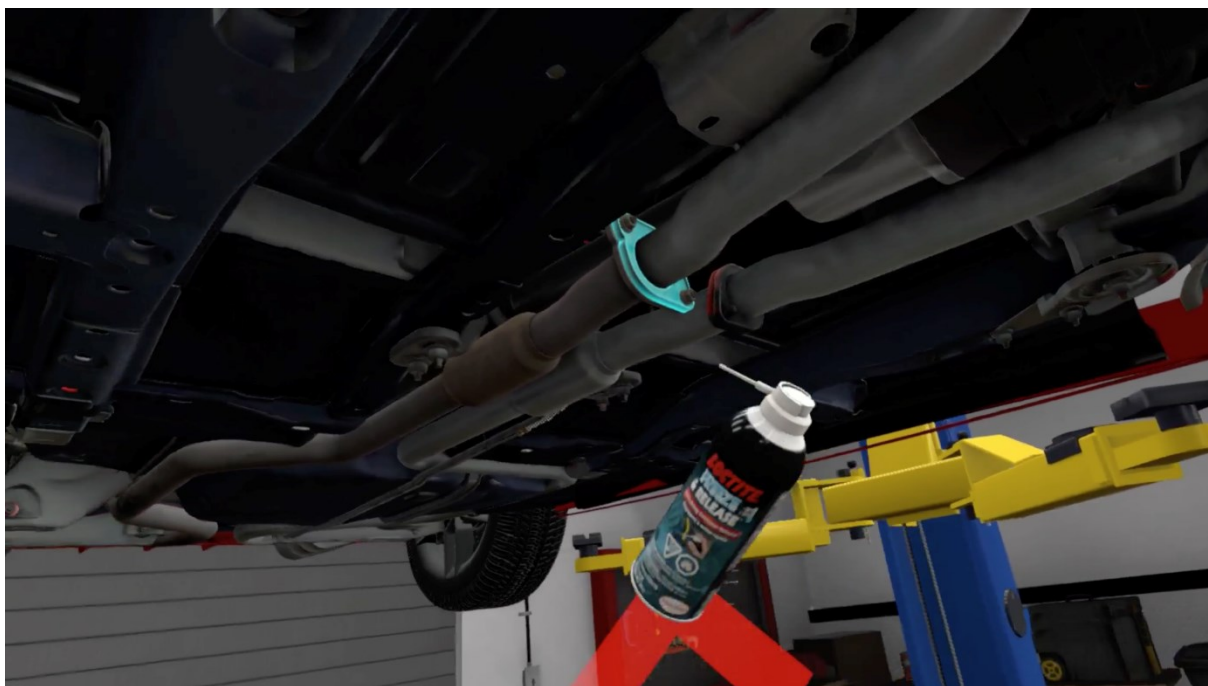
Obrázek 15 Nanesení produktu proti korozi při výměně tlumiče výfuku (Groove Jones, 2018)
