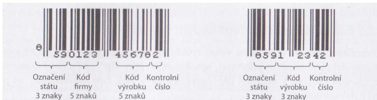
Obrázek 4 Příklady struktury čárového kódu (Gros et al., 2016, s. 411)
