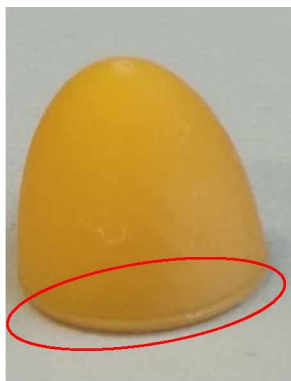
Obrázek 2: Zaoblení okraje v místě kontaktu SLA výtisku s tiskovou hlavou
