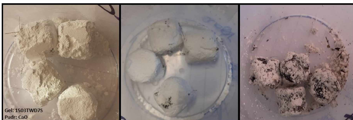
Obrázek 66 Pelety ze solidifikátu 1503TWD7S obalené v CaO. Vlevo před třepáním, uprostřed po horizontální třepáče, vpravo po rotační třepáče
