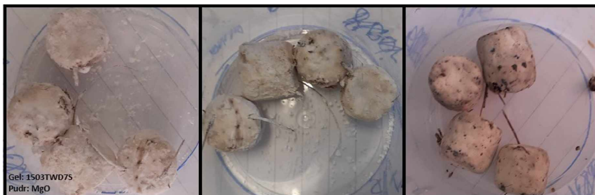
Obrázek 69 Pelety ze solidifikátu 1503TWD7S obalené v MgO. Vlevo před třepáním, uprostřed po horizontální třepačce, vpravo po rotační třepačce
