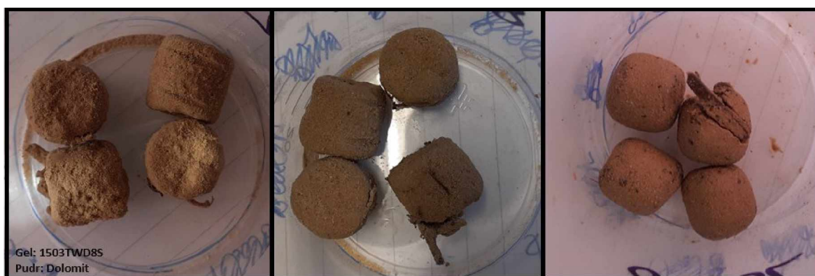
Obrázek 71 Pelety ze solidifikátu 1503TWD8S obalené v dolomitu. Vlevo před třepáním, uprostřed po horizontální třepačce, vpravo po rotační třepačce
