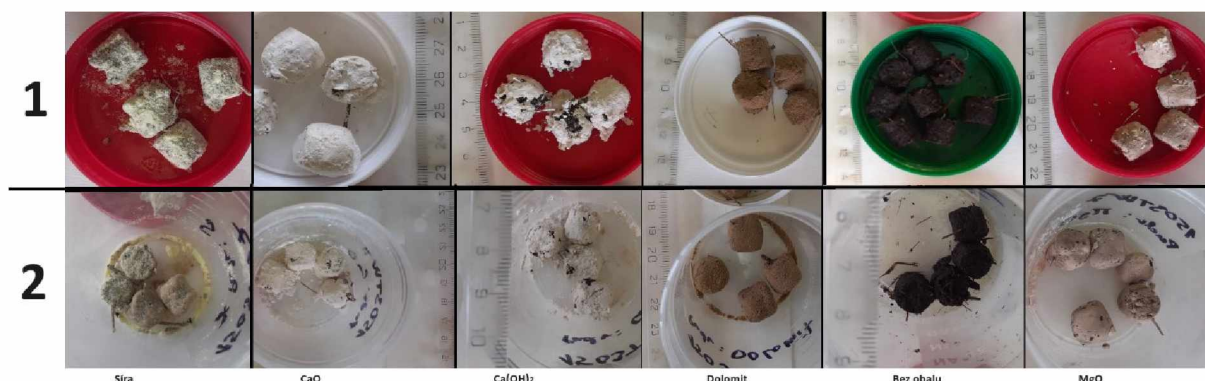
Obrázek 75 Pelety z 1503TWD7S. Řádek označený s číslem 1 pelety před třepání a řádek číslo 2 pelety po třepání.
