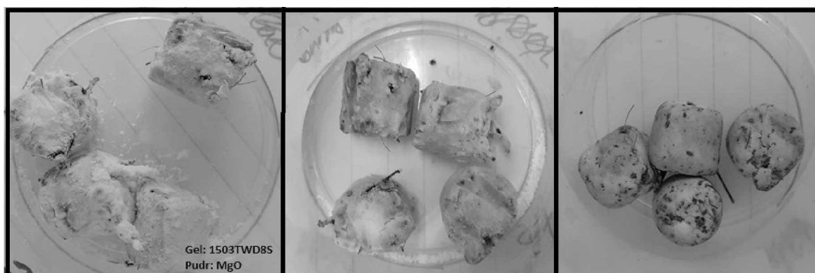
Obrázek 74 Pelety ze solidifikátu 1503TWD8S obalené v MgO. Vlevo před třepáním, uprostřed po horizontální třepačce, vpravo po rotační třepačce
