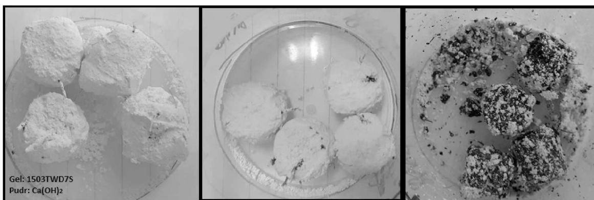
Obrázek 65 Pelety ze solidifikátu 1503TWD7S obalené v \text{Ca(OH)}_2 . Vlevo před třepáním, uprostřed po horizontální třepačce, vpravo po rotační třepačce
