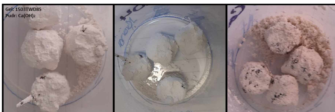
Obrázek 70 Pelety ze solidifikátu 1503TWD8S obalené v \text{Ca}(\text{OH})_2 . Vlevo před třepáním, uprostřed po horizontální třepačce, vpravo po rotační třepačce
