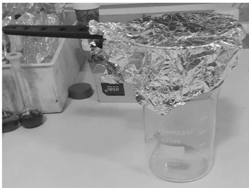
Obrázek 6 Aparatura pro odvodnění digestátu/fugátu smíchaného se sorbentem
