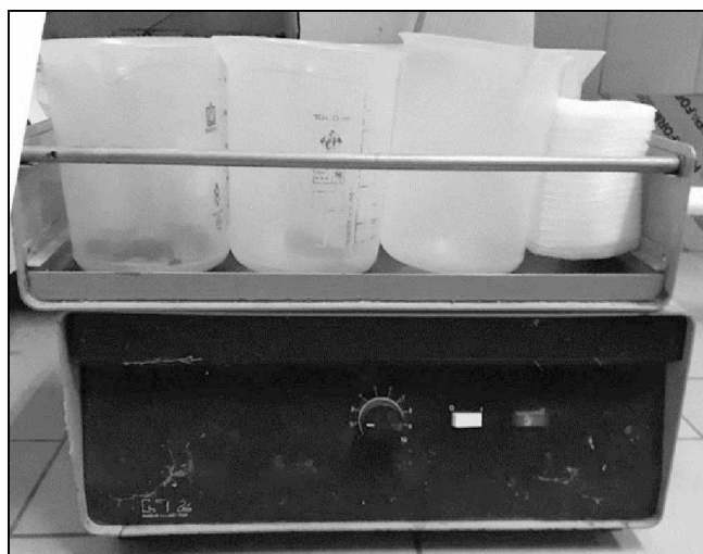
Obrázek 9 Třepačka Laboratoř Písek s horizontálními kmity
