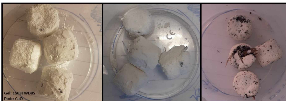
Obrázek 72 Pelety ze solidifikátu 1503TWD8S obalené v CaO. Vlevo před třepáním, uprostřed po horizontální třepače, vpravo po rotační třepače
