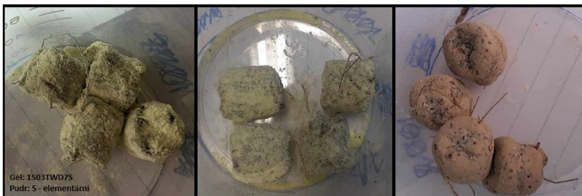
Obrázek 68 Pelety ze solidifikátu 1503TWD7S obalené v elementární síře. Vlevo před třepáním, uprostřed po horizontální třepačce, vpravo po rotační třepačce
