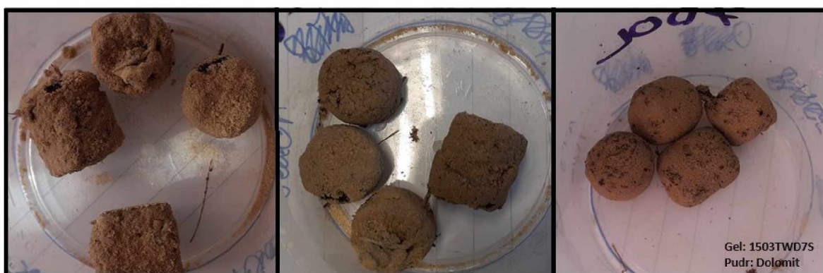
Obrázek 67 Pelety ze solidifikátu 1503TWD7S obalené v dolomitu. Vlevo před třepáním, uprostřed po horizontální třepáče, vpravo po rotační třepáče
