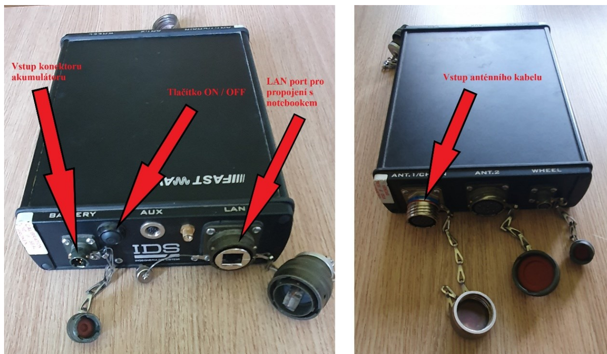
Obrázek 13: Použitá kontrolní a řídicí jednotka DAD FAST WAVE (vlastní zpracování)
