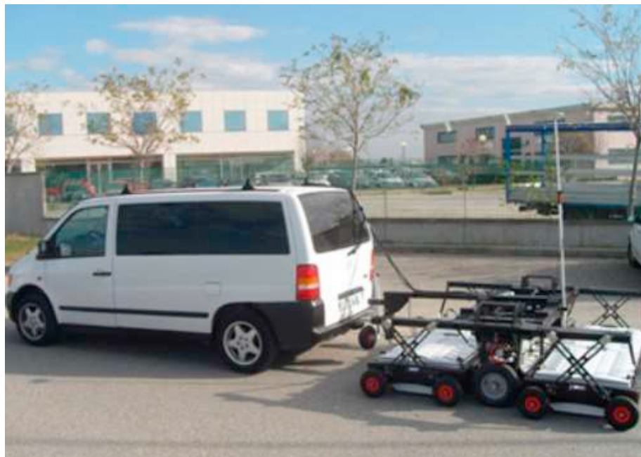
Obrázek 11: Soustava systému GPR STREAM EM (Sářácin, 2017, s. 218)
