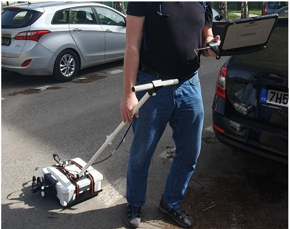
Obrázek 12: Použitá sestava GPR při měření (vlastní zpracování)
