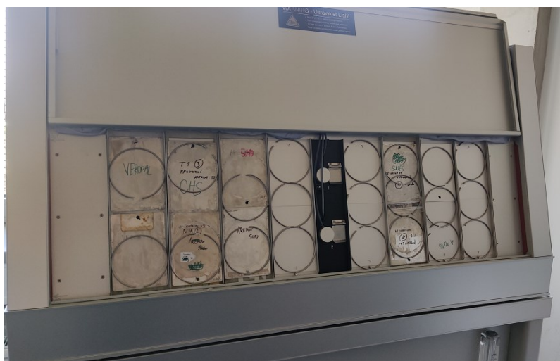
Obrázek 35: Způsob umístění vzorků v testovací komoře QUV.
