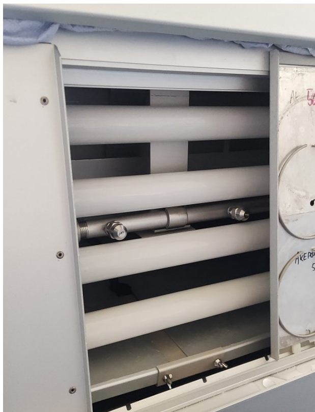
Obrázek 34: Lamy produkující UV záření v testovací komoře QUV.
