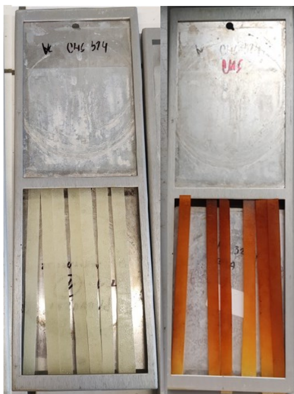
Obrázek 39: Vzorek CHS EPOXY 324 před osvitem (vlevo) a ten samý vzorek po 30 dnech v QUV komoře (vpravo)
