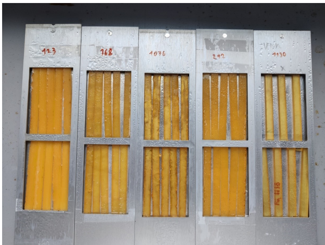
Obrázek 43: Vzhled vzorků s přidávanými stabilizátory po jednom měsíci v QUV komoře
