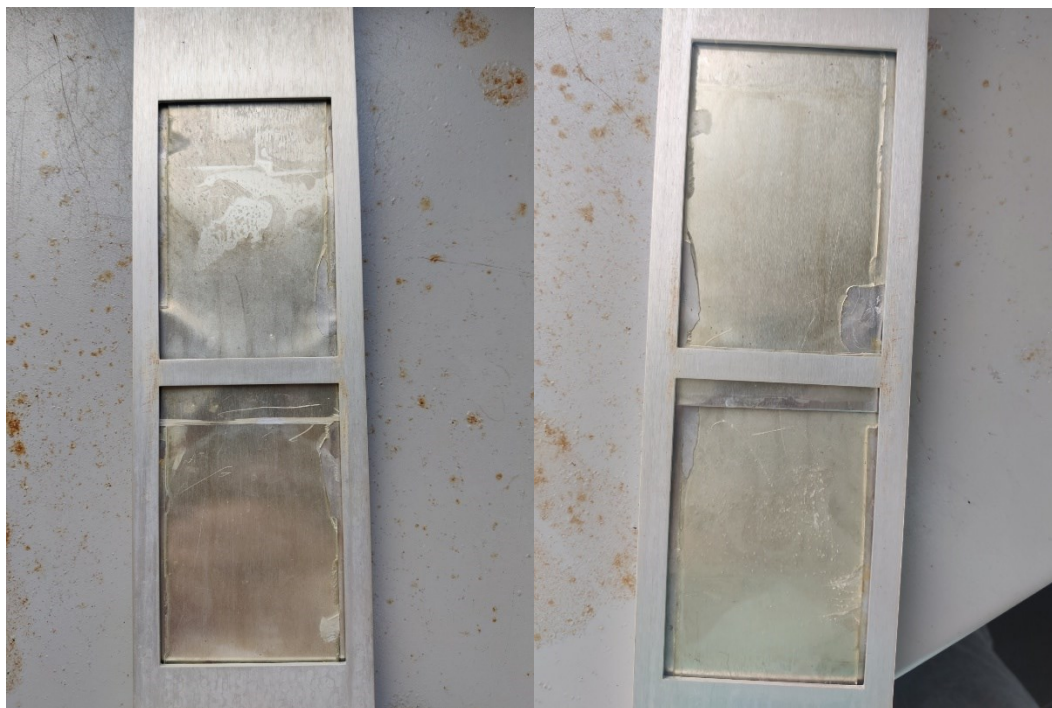
Obrázek 41: Vzorek pryskyřice Veropal UV + 100 po 1 dni (vlevo) a po 5 dnech v QUV komoře (vpravo)
