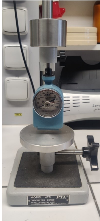
Obrázek 31: Tvrdoměr, na kterém bylo prováděno měření tvrdosti metodou Shore D.
