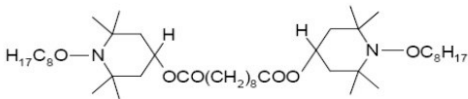
Obrázek 23: UV stabilizátor LS-123 - Bis-(1-oktyloxy-2,2,6,6-tetramethyl-4-piperidiny)l) sebakát
