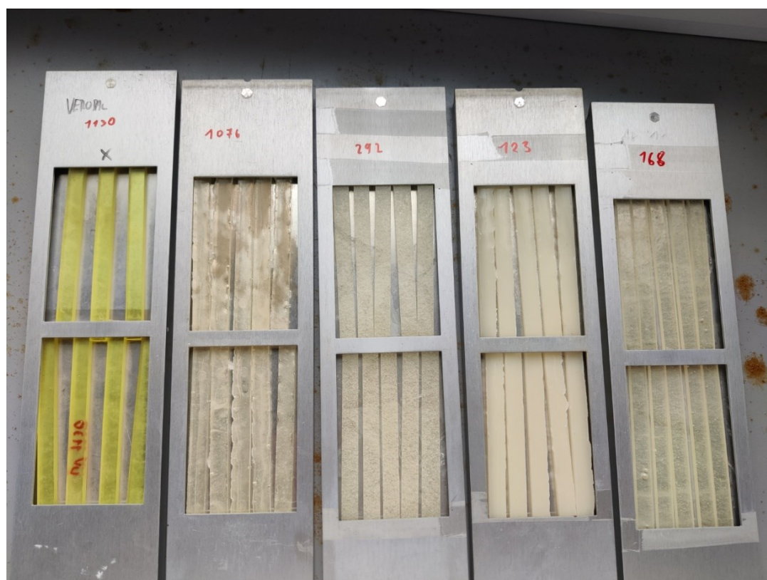
Obrázek 42: Vzhled vzorků s přidávanými stabilizátory před vložením do QUV komory
