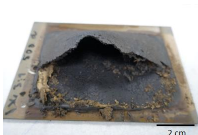
Obrázek 43: Příklad separace zpěněné vrstvy od podkladu u epoxyesterové pryskyřice EST/3:1 při 500°C
