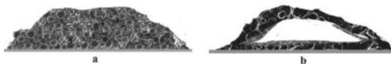
Obrázek 5: Příklady a) správně vytvořené zpěněné vrstvy, b) nesprávně vytvořené zpěněné vrstvy [20]
