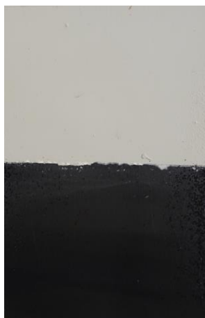
Obrázek 47. Zkouška odolnosti proti vlhkosti, \text{TiO}_2 , OKP = 16,2 %, 960 h, DFT = 105 \pm 5 \mu\text{m} .
