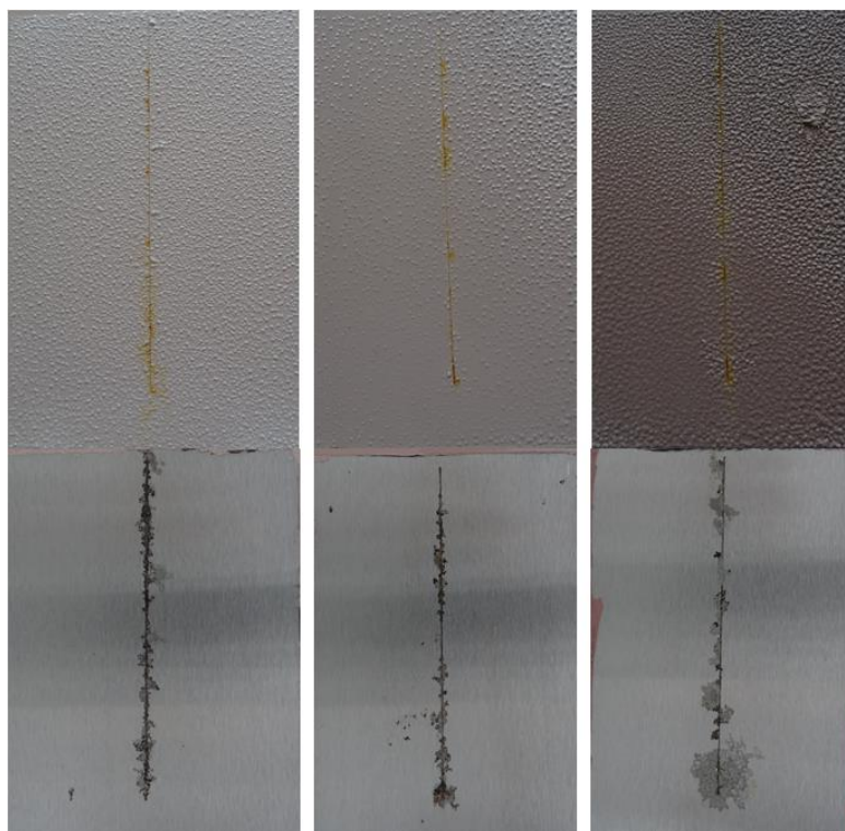
Obrázek 74. Zkouška odolnosti proti vlhkosti s obsahem \text{SO}_2 , \text{MgFe}_2\text{O}_4 , OKP = 3, 5 a 10 %, 960 h, DFT = 110 \pm 5 \mu\text{m} .
