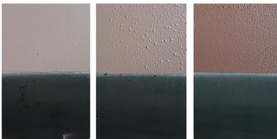
Obrázek 37. Zkouška odolnosti proti vlhkosti, \text{Zn}_{0,4}\text{Mg}_{0,6}\text{Fe}_2\text{O}_4 , OKP = 3, 5 a 10 %, 960 h, DFT = 105 \pm 5 \mu\text{m} .
