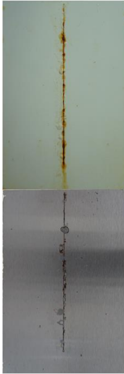
Obrázek 60. Zkouška mlhou solného elektrolytu, \text{TiO}_2 , OKP = 16,2 %, 1440 h, DFT = 120 \pm 5 \mu\text{m} .
