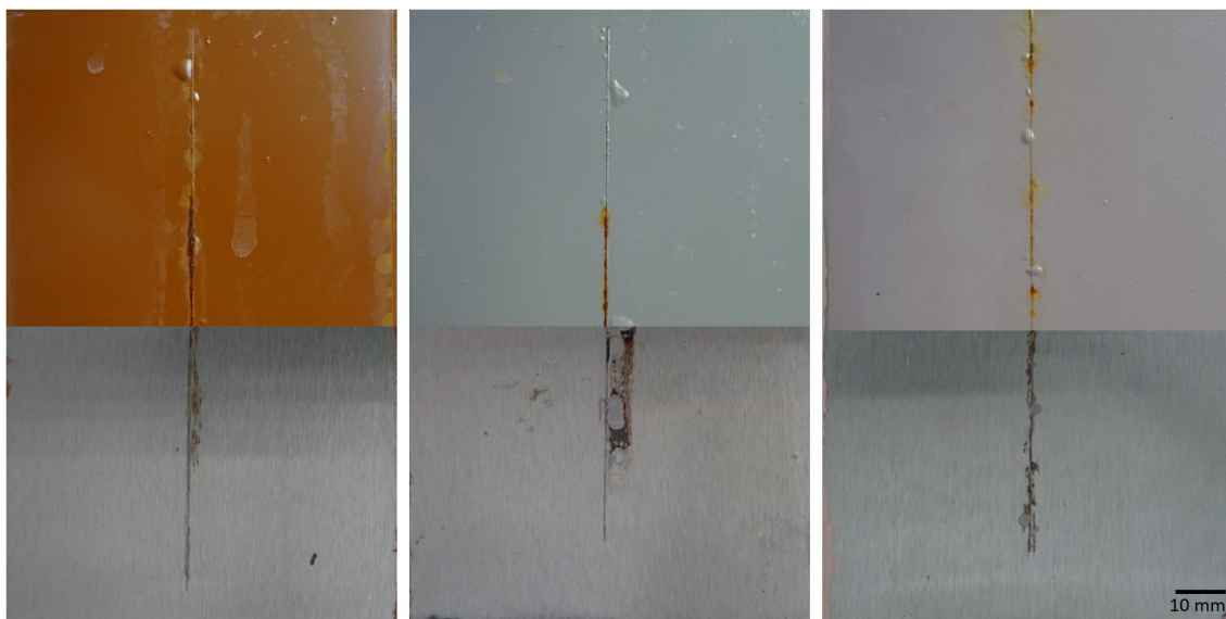
Obrázek 29. Zkouška mlhou solného elektrolytu, \text{ZnFe}_2\text{O}_4 , \text{ZnFe}_2\text{O}_4 pokrytý PANI, \text{MgFe}_2\text{O}_4 , OKP = 5 % 1440 h, DFT = 120 \pm 5 \mu\text{m} .
