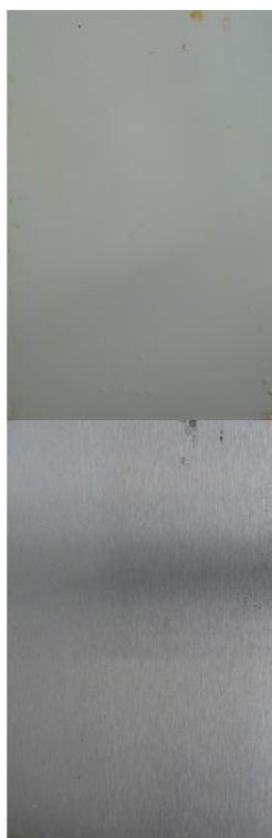
Obrázek 73. Zkouška mlhou solného elektrolytu, \text{TiO}_2 , OKP = 16,2 %, 1920 h, DFT = 110 \pm 5 \mu\text{m} .
