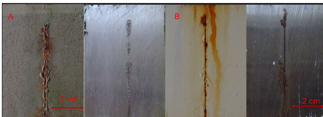
Obrázek 32. Fotografie vybraných povlaků na bázi epoxyesterových pryskyřic a ocelových panelů po jejich odstranění s nejvyšší antikorozní odolností po 1080 hodinách ve směsné atmosféře pigmentovaných A) C_{20}H_{12}N_2O_4Mg o OKP 10 %, B) C_{12}H_{21}N_1O_4Zn o OKP 1 %
