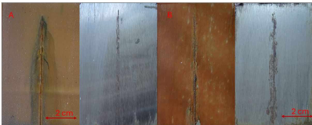
Obrázek 33. Fotografie vybraných povlaků na bázi alkydových pryskyřic a ocelových panelů po jejich odstranění s nejvyšší antikorozií odolností po 720 hodinách ve směsné atmosféře pigmentovaných A) C_{20}H_{12}N_2O_4Mg o OKP 10 %, B) C_{20}H_{12}N_2O_4Zn o OKP 10 %
