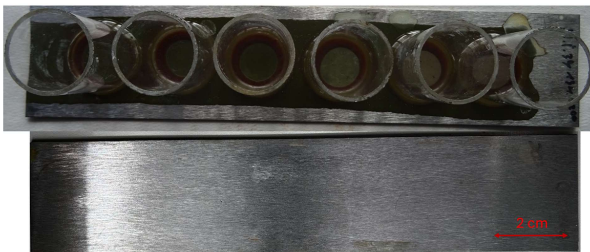
Obrázek 37. Fotografie vybraného organického povlaku na bázi epoxidové pryskyřice obsahující pigment C_{20}H_{12}N_2O_4Mg po 720 hodinách působení pufrů a fotografie ocelového panelu po stažení povlaku
