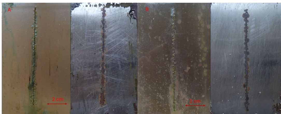
Obrázek 28. Fotografie vybraných povlaků na bázi epoxidové pryskyřice a ocelových panelů po jejich odstranění s nejvyšší antikorozií odolností po 1200 hodinách v atmosféře obsahující SO 2 pigmentované A) C 20 H 12 N 2 O 4 Mg o OKP 10 %, B) C 20 H 12 N 2 O 4 Zn o OKP 10 %.
