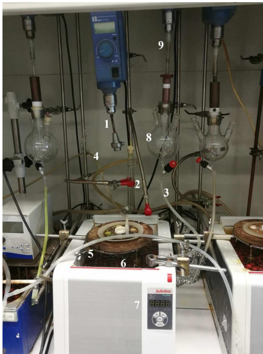
Obr. 5: Reakční aparatura emulzní polymerace: 1 – míchadlo, 2 – zpětný chladič, 3 – přívod monomerů, 4 – přívod inertního plynu ( N_2 ), 5 – polymerační reaktor, 6 – vodní lázeň, 7 – termostat, 8 – emulgační baňka, 9 – rychloběžné míchadlo
