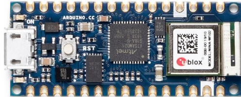
Obr. 2.7 – Deska Arduino Nano 33 IoT (Arduino Nano 33 IoT, nedatováno)
