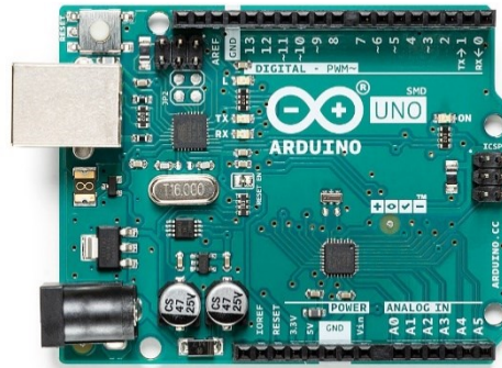
Obr. 2.3 – Deska Arduino Uno REV3 SMD (Arduino Uno REV3 SMD, nedatováno)
