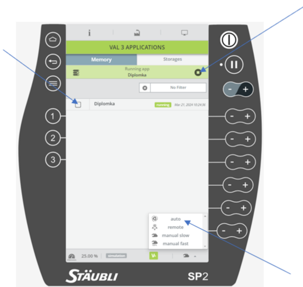
Obrázek B1 Nahrání programu do paměti RAM
