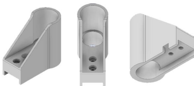
Obrázek 2.3 Tisk nástavce na enkodér (vlastní, 2024)
