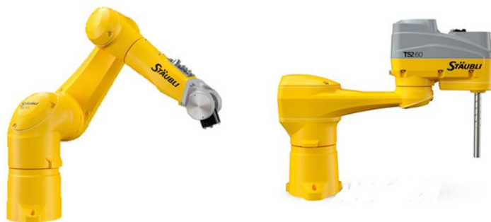
Obrázek 1.8 Stäubli robotický manipulátor šestiosý, SCARA (Stäubli, 2023)
