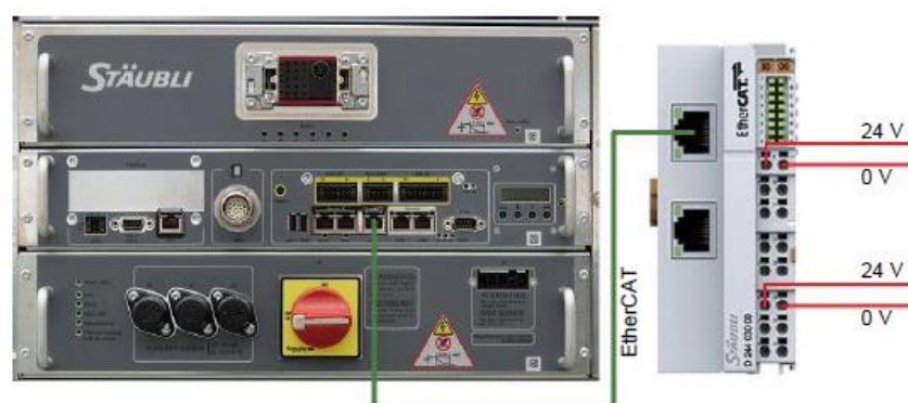
Obrázek 2.16 Zapojení modulu Coupler EtherCat (Stäubli, 2024)
