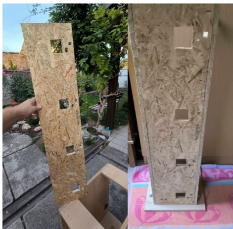
Obrázek 9.2 – Výřez a následné spojení stěn
