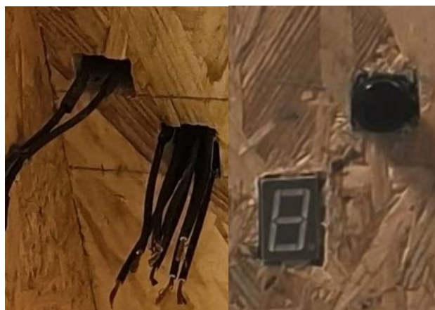
Obrázek 12.2 – Umístění displeje a tlačítka přední a zadní strana
