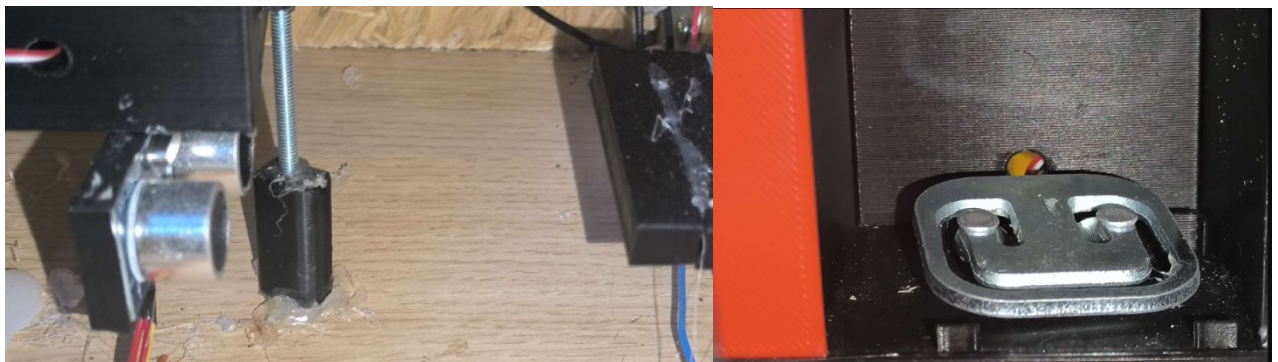
Obrázek 12.5 – Upevnění snímače s umístěním váhy
