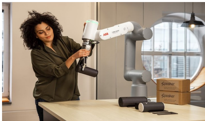
Obr. 1.11 – Příklad kolaborativního robota (ABB uvádí na trh kolaborativní robot GoFa™ s nosností do 5 kg, 2021)
