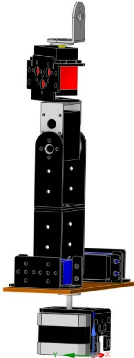
Obr. 3.7 - Sestava zápěstí robotického ramene (Vlastní tvorba, navrženo v DesignSpark Mechanical)
