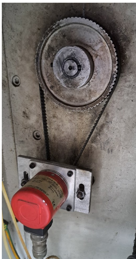
Obrázek 24 Příklad mechanického propojení enkodéru a měřené soustavy
