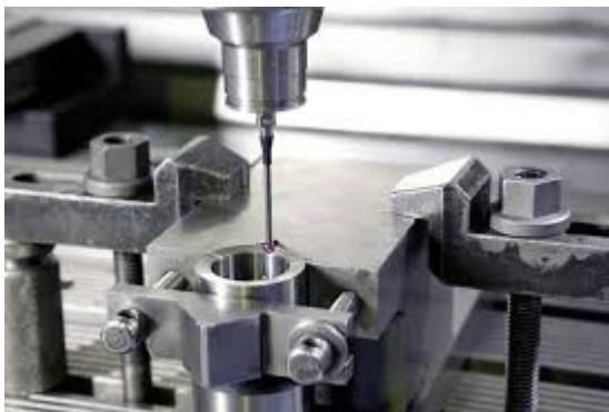
Obrázek 1 Měření dotykovou sondou [22]
