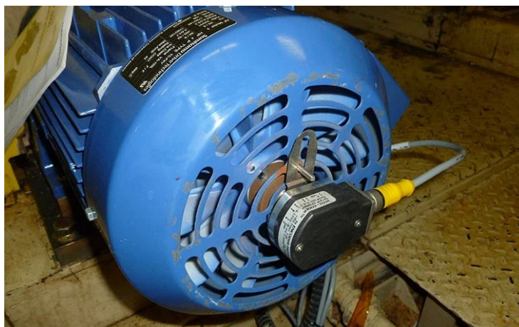
Obrázek 25 Příklad použití enkodéru pro snímání polohy asynchronního motoru [33]
