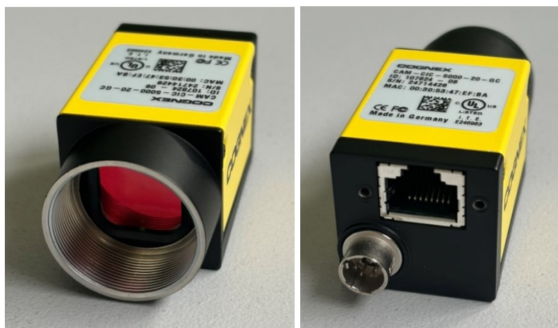
Obrázek 16 – Industriální kamera CIC 5000, detail snímače a zadních konektorů
