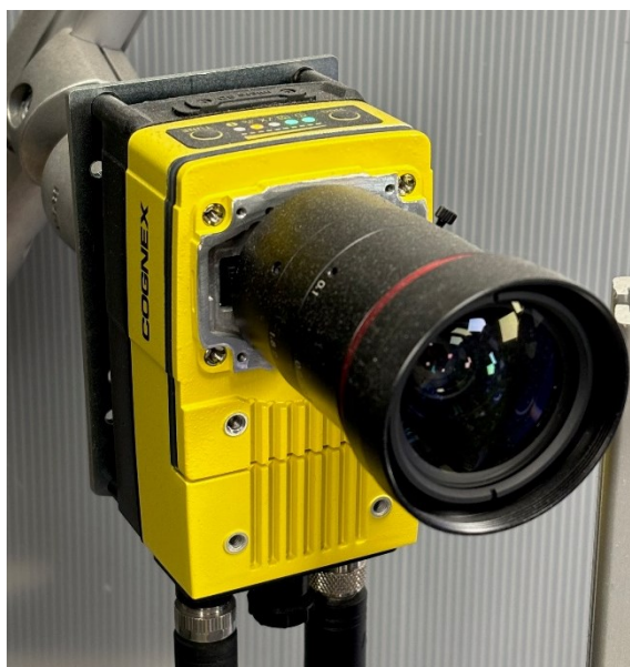
Obrázek 9 – Inteligentní kamera In-Sight D900 na bráně kamerové inspekce TMMCZ
