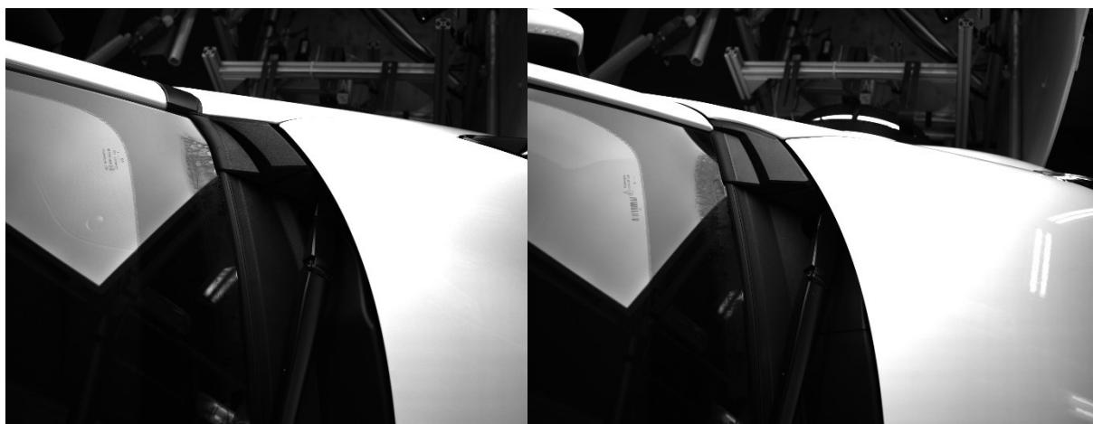
Obrázek 21 – Finální nastavení obrazu pro štítek čelního skla modelu Aygo a Yaris
