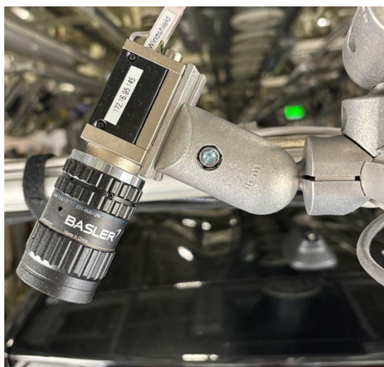
Obrázek 20 – Finalní montáž kamery Basler ace L na inspekční bránu
