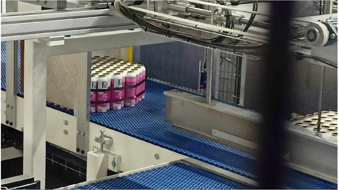
Obrázek 9: optická brána zjišťující polohu objektu
